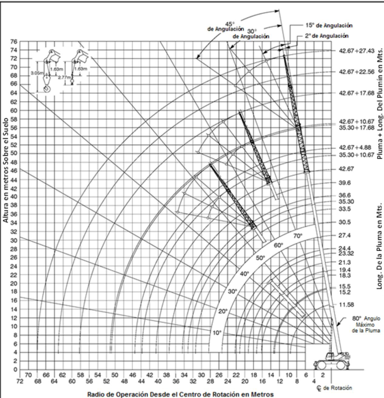
**Nota:** La geometría de la pluma y del plumín que se muestran son para una condición sin carga y la grúa nivelada sobre una superficie firme de soporte. La deflexión de la pluma, el radio subsecuente y el cambio del ángulo de la pluma, deben ser considerados para cuando aplique carga al gancho.
